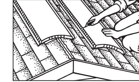
Paso 4 – Utilice el cíter para cortar la sección final en el largo adecuado. El extremo de la sección final debe estar alineada con el final del techo, asegurándose de que el conector final integrado esté expuesto. Para bordes con un largo menor al del producto, córtelo según sea necesario. Luego córtelo lo más cerca posible y correctamente orientado respecto del conector final. Invierta esta sección corta de forma tal que el conector final esté alineado con el final del techo.
