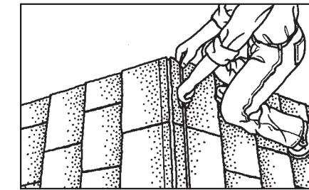
Paso 1 – En un techo ya instalado, quite las tejas. Marque el ancho de la ranura a ambos lados del borde. Utilice como guía ranuras marcadas sobre la ventilación y consulte los dibujos en la otra página. Trace una línea con tiza a ambos lados del borde.
